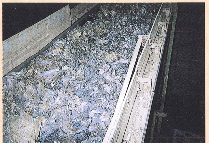
廃プラはカッティングされ、洗浄してリサイクルへ
